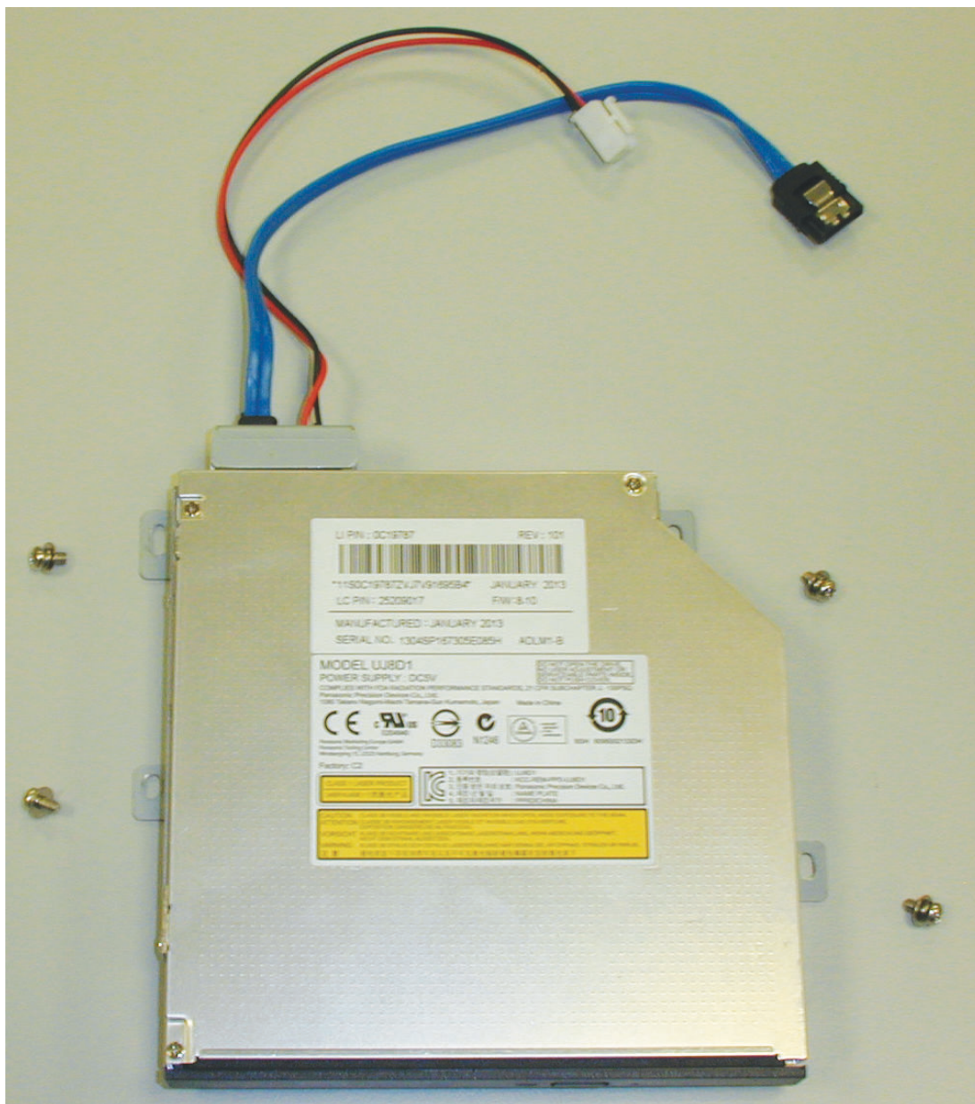
Figure 5.11: Installation des composants du lecteur DVD (DIVAR 3000)
