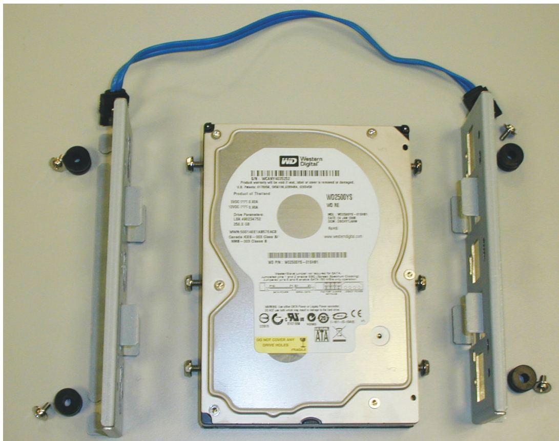
Figure 5.7: Composants d'installation du disque dur (DIVAR 5000)
