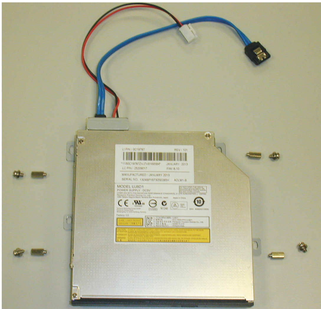
Figure 5.13: Installation des composants du lecteur DVD (DIVAR 5000)
